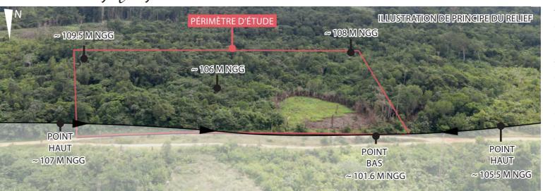
Topographiquement, le site suit des ondulations légères et irrégulières, avant tout perceptibles dans la perspective ouverte de la piste formant la limite orientale et faisant apparaître le site en renfoncement le long de la piste et à une échelle assez large (en point bas délimité par des points hauts au-delà de quelques dizaines de mètres de chacune des extrémités).
